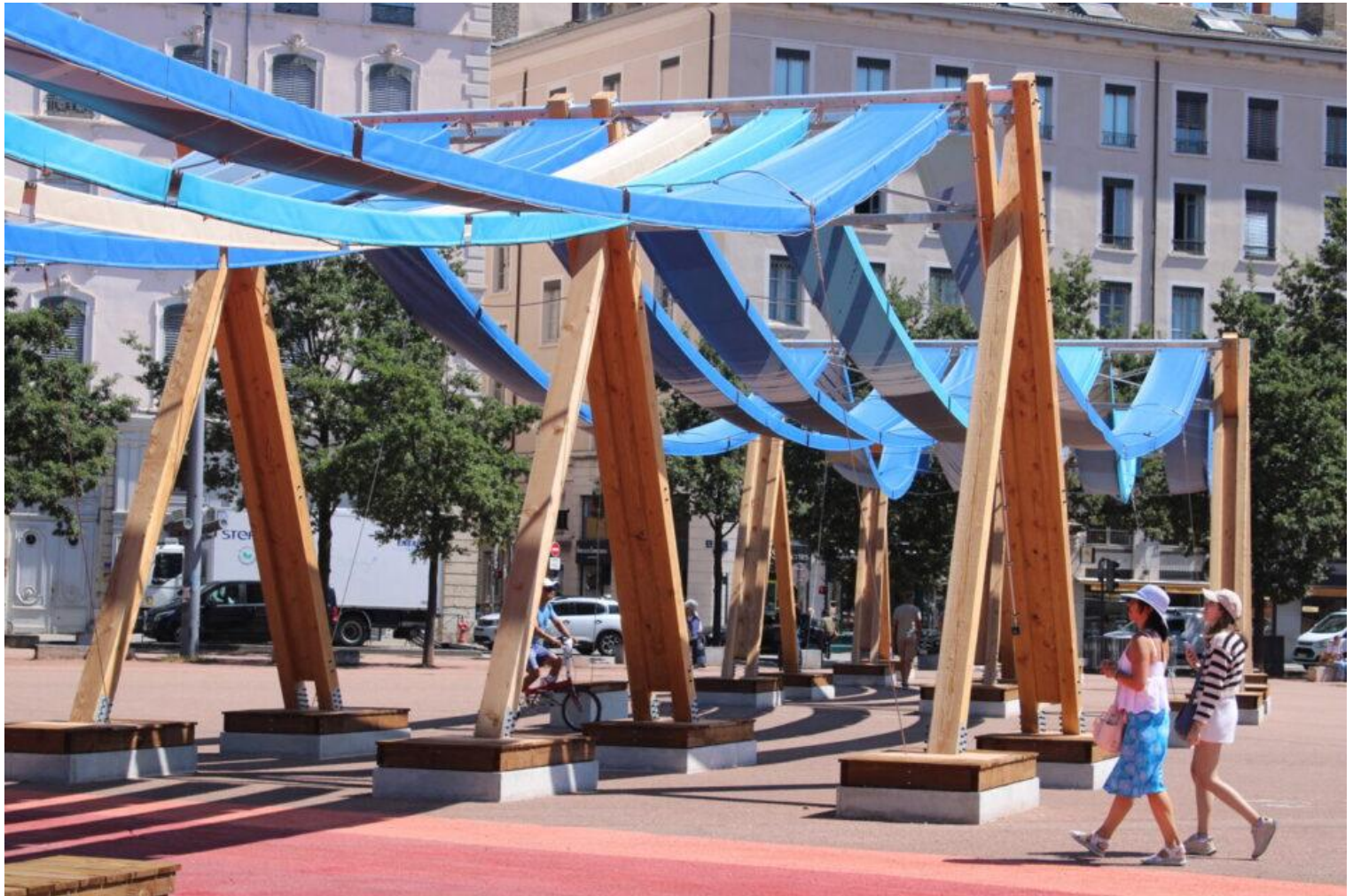
Des brumisateurs ont été installés sous les ombrières bleues de Tissage urbain. (©Anthony Soudani / actu Lyon)
